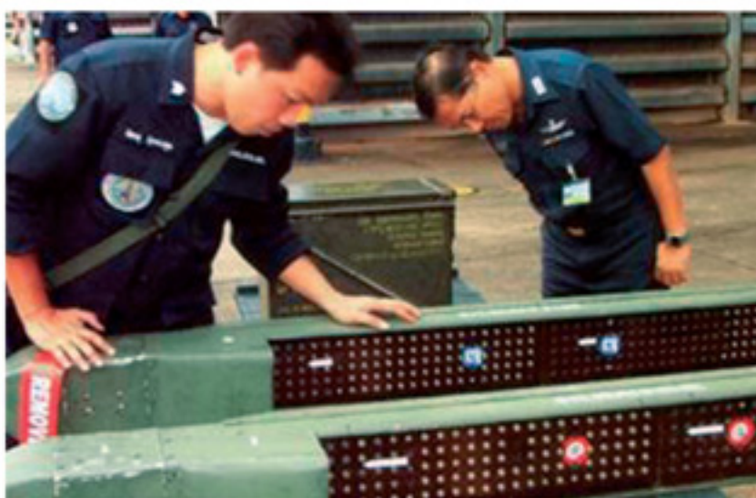
เจ้าหน้าที่กำลังติดตั้งเครื่องอิงพลูซิลเวอร์ไอโอไดค์ ที่กองทัพอากาศประดิษฐ์ขึ้นเพื่อใช้ในการทำผ่านหลวง
